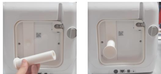
5. Introducir el extremo de la boquilla en el conector superior del adaptador según se indica en la imagen hasta que haga tope.
