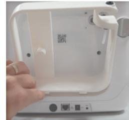
3. Presionar en la parte superior del adaptador hasta que encaje perfectamente todo el marco del adaptador, sobre todo en la parte del extrusor.
