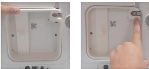
4. Situarnos detrás de la impresora y girar la rueda gris en sentido antihorario hasta la posición indicada en la imagen, para que el adaptador quede fijado y enroscar el portabobinas.
