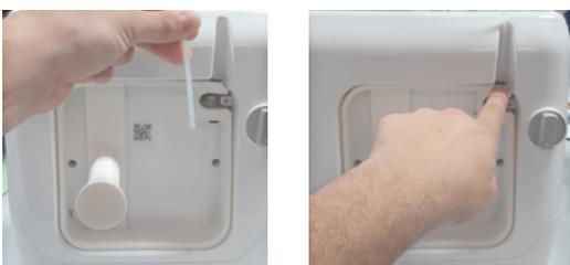
6. Por último, colocar la bobina en el portabobinas e introducir el extremo del filamento a través del tubo guía inferior del adaptador hasta que toque el engranaje.
